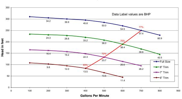
3X4X9A 9" Impeller 3500 RPM
